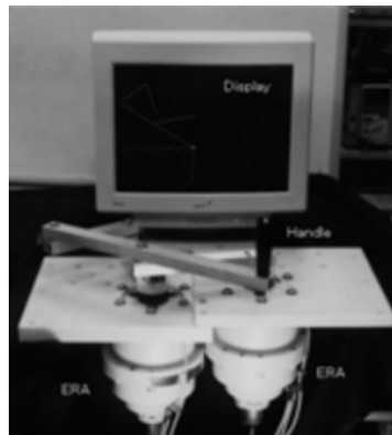
Figura 2.4: Sistema de rehabilitación NIOH-1.
