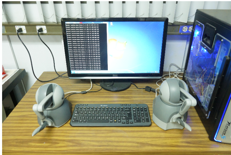
Figura 3.3: Sistema de rehabilitación bilateral para miembro superior de paciente de EVC, asistida por robots.
