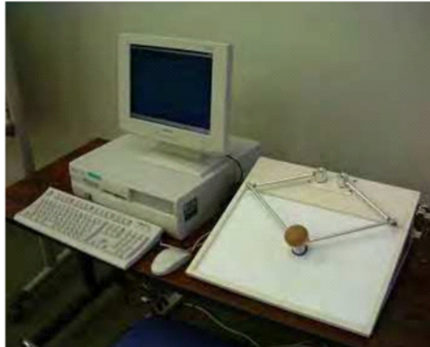
Figura 2.6: Dispositivo háptico para la rehabilitación de miembro superior.
