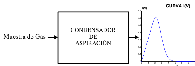
Figura 6.9: Curva de voltaje contra corriente I(V) producida por el condensador de aspiración con barrido de campo.
