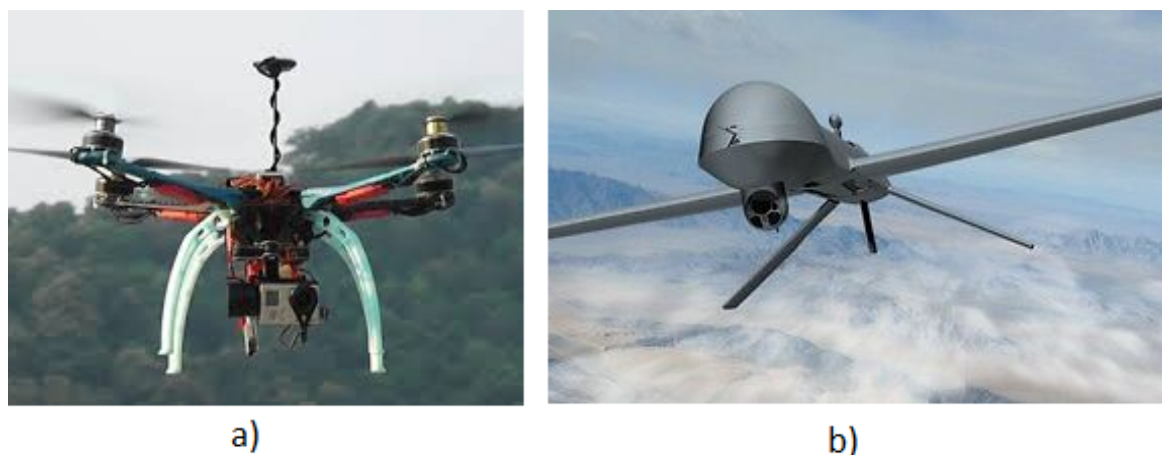
Figura 1.3: Robots autónomos aéreos: a) cuadricóptero, b) RPA (del inglés Remotely Piloted Aircraft).
